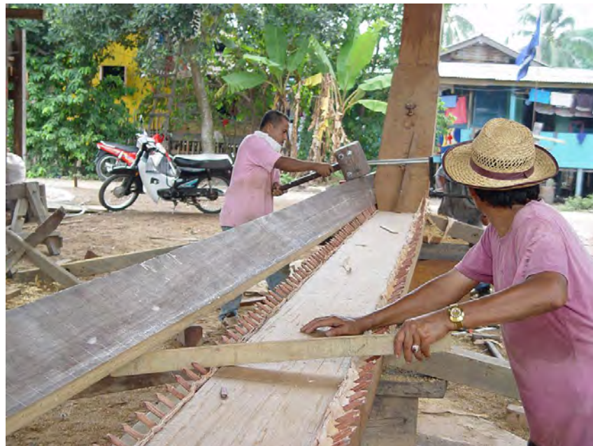
Figure 16: Membina badan kapal daripada lunas dengan mengatur dan memasukkan papan badan kapal satu demi satu ke dalam cemat kayu ( http://en.wikipedia.org/wiki/Naga_Pelangi )
