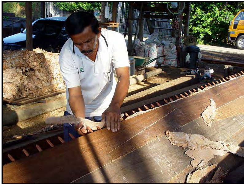
Rajah 17: Membentuk Badan kapal (Hull) dengan mengatur papan satu demi satu ke cemat kayu atau woden dowel dan meletakkan kulit kayu gelam sebagai gam ( http://en.wikipedia.org/wiki/Naga_Pelangi )
